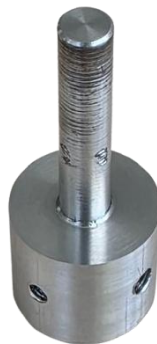
Figure 28 — Extension de l'arbre du moteur, usinée (tournage CNC puis conventionnel).
