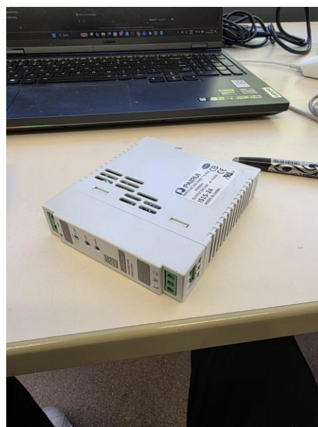
Figure 38 — Alimentation de puissance 24 V.
