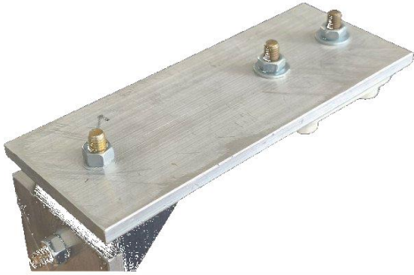
Figure 33 — Plaque support en aluminium (caméra), usinée.
