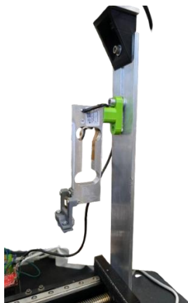
Figure 29 — Support aluminium usiné, cellule de charge et pièce d'adaptation.
