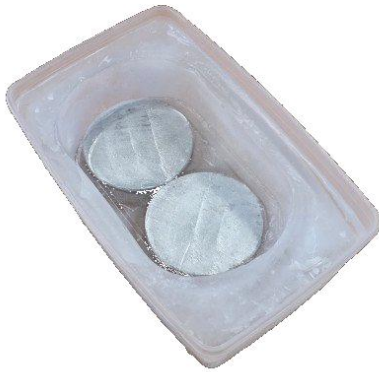
Figure 47 — Moule à glace utilisé pour l'essai à froid.
