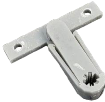
Figure 30 — Mors SnapFit imprimé en résine.
