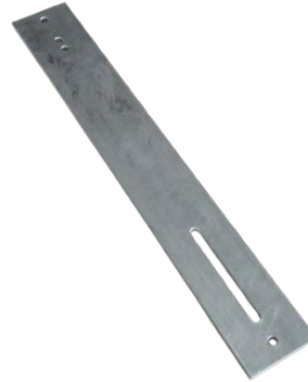
Figure 34 — Plaque support en aluminium (cellule de charge) usinée.
