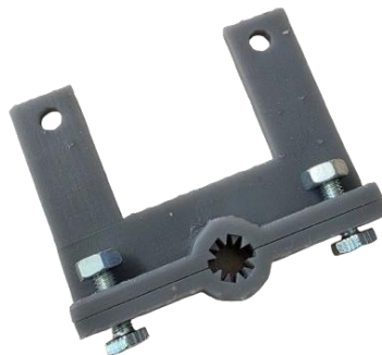
Figure 32 — Mors vis-écrou imprimé en résine (concept retenu).
