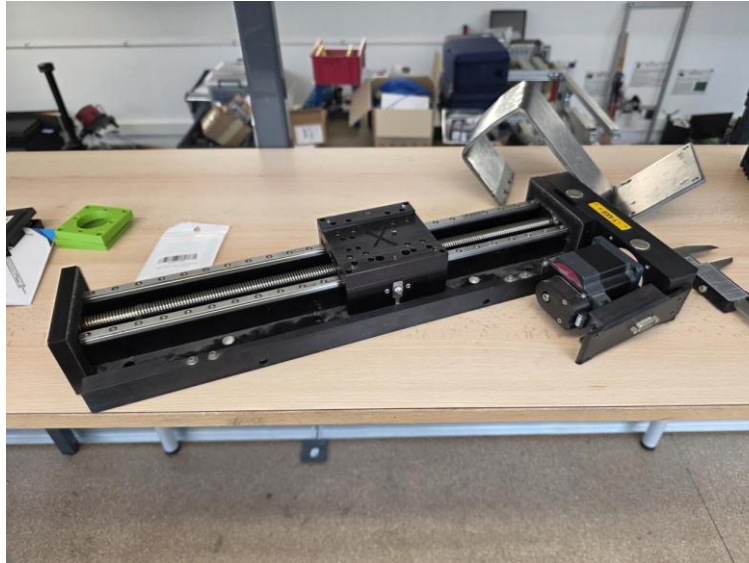
Figure 10 — Squelette du guidage linéaire fourni (moteur, courroie, vis et chariot portant les capteurs de fin de course).
